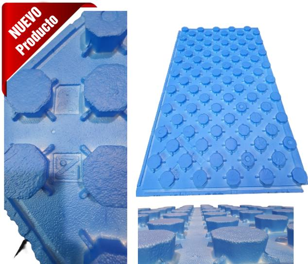
Placa de EPS plastificada, para suelo radiante, conforme a la norma UNE EN13163, de superficie moldeada y laterales machihembrados. Cada placa de Poliradiante tiene un acabado machihembrado a cuatro cantos, que permite colocarlas de forma sencilla y que evite los puentes térmicos. Mientras que el diseño troncocónico de los tetones, facilita que las tuberías queden sujetas de una forma rápida y eficaz, sin necesidad de usar grapas ni otro tipo de complementos.
